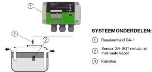
Afbeelding 1. Bewaking vetafscheider met alarmtoestel GA-1
