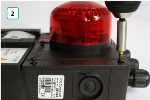
4. AM / AM PLUS Einheit öffnen. Hierzu werden die fünf Befestigungsschrauben ④ für den Installationsbereich entfernt. Beachten Sie beim Öffnen des Geräts, dass Sie bei einer AM PLUS Einheit die Signallampe abstecken.
