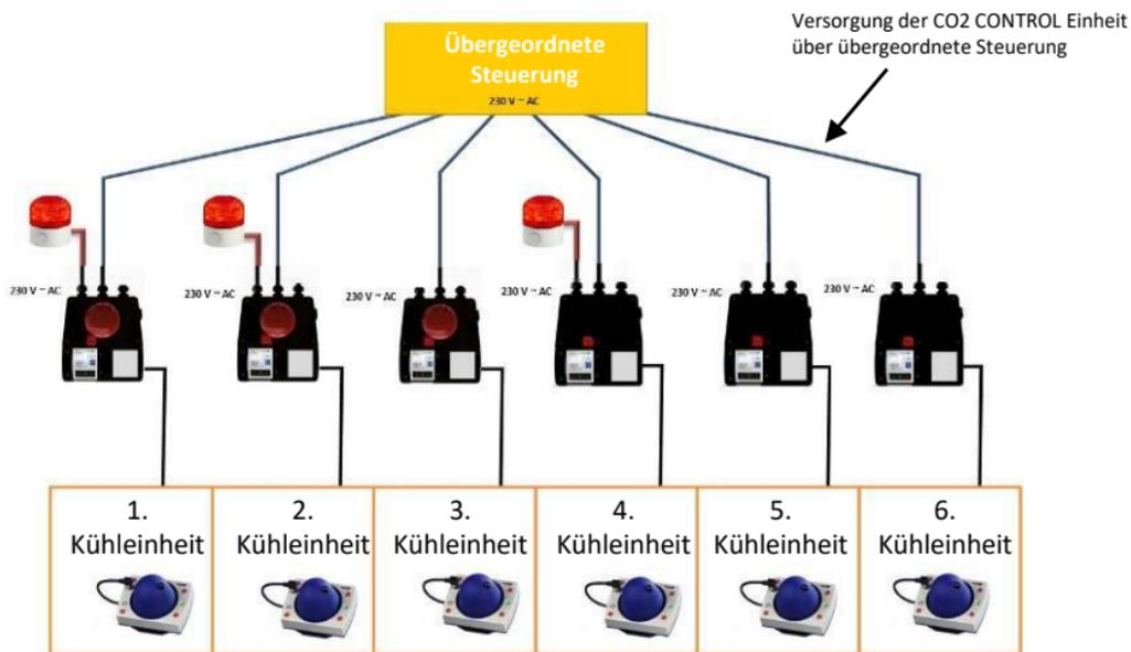
In Lebensmittelmärkten werden Kühlräume, Tiefkühlräume und Maschinenraum meist mit CO<sub>2</sub> CONTROL AM abgesichert. Die Alarm- und Störungsmeldung wird auf die Kältesteuerung aufgeschaltet. Quittierung der Alarme erfolgt direkt dezentral am Aufsatzmodul.
