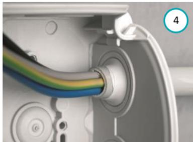
Ist eine höhere IP-Klasse als IP66 notwendig, muss für die Durchführung eine M20-Verschraubung verwendet werden (nicht im Lieferumfang enthalten). Hierfür entfernen Sie die Membran komplett und bringen stattdessen die M20-Verschraubung an (5).
