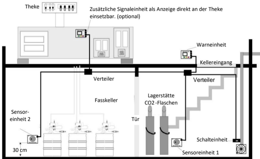
b.) Aufbau CO2 CONTROL Aufsatzmodul für eine CO<sub>2</sub> Kälteanlage
