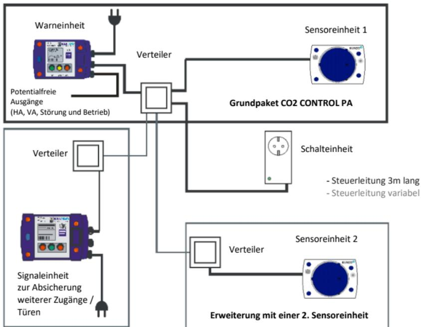
Die Variante CO2 CONTROL wird über die Steuerleitung von der GLT& / Steuerung versorgt.
